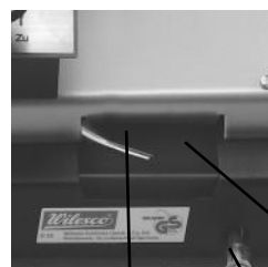
Speisewasserbecken Ablassschraube für Speisewasserbecken Rücklaufrohr Speisewasserpumpe
